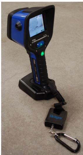
Das erste Halbjahr 2013 gab wieder Anlass zur Freude. Bei unserer Wehr wurde im Rahmen des Amtsfeuerwehrkonzeptes eine Wärmebildkamera (Dräger UFC 6000) stationiert, welche seit dem im gesamten Amt Berkenthin zum lokalisieren von verborgenen Wärme-, Glut- und Feuerstellen bei Brandeinsätzen, sowie zur Personensuche in Gebäuden, bei schlechten Sichtverhältnissen und Dunkelheit, bei allen entsprechenden Alarmierungen durch uns zum Einsatz kommen wird.
